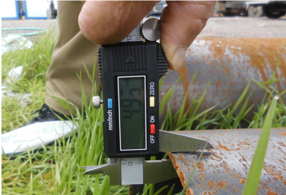
Çelik İçme Suyu Ve Kılıf Boru Profillerinin Et Kalınlığı Ölçümü
