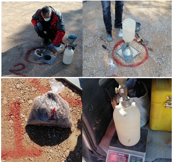
Kum Konisi Metodu İle Sıkışma Testi
