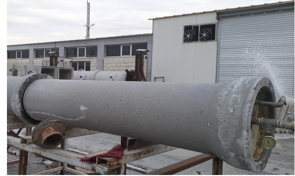
ECBB Beton Boruların Sızdırmazlık Testi
